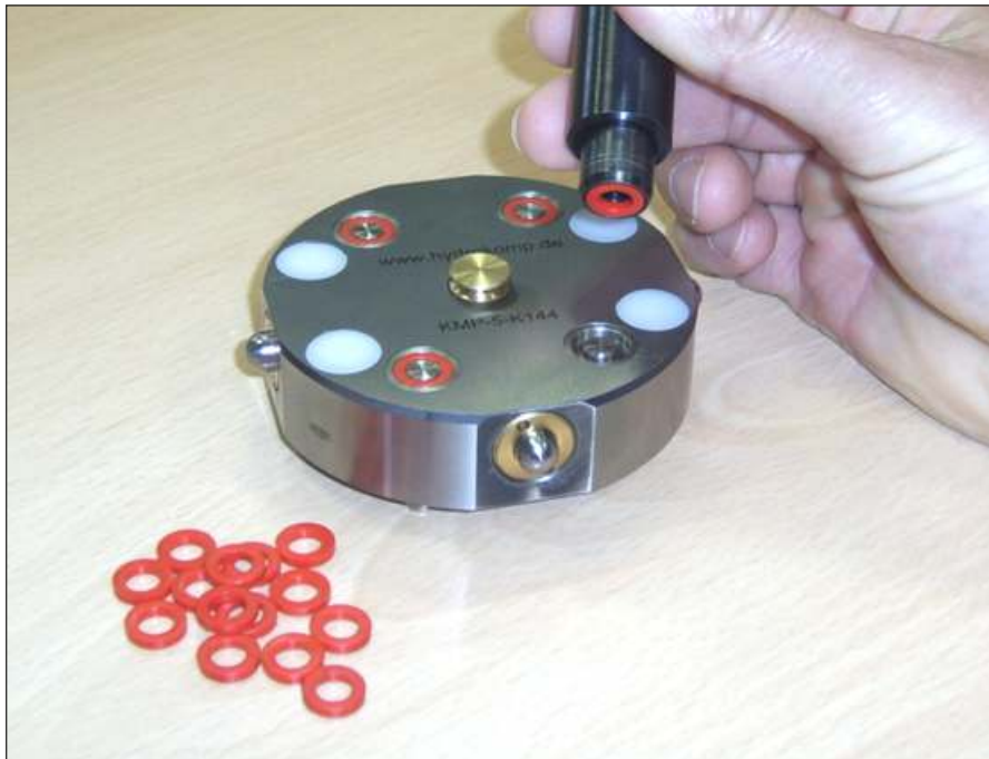
Montagewerkzeug mit Dichtungsring bestückt, vor dem Einpressen in die Kupplungsmechanik
