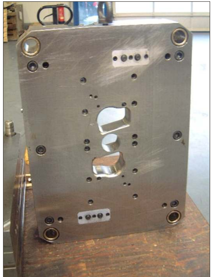
Plaque outil frontale, positionnement à symétrie de révolution des coupleurs mâles pour une position à 0° ou 180°.
