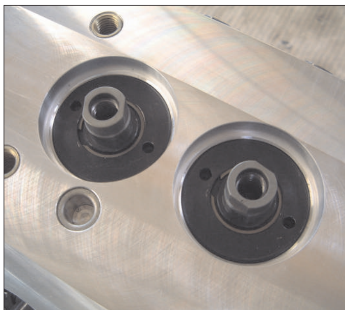
Hydraulische Einschraubzylinder, einfach wirkend mit Federrückstellung
