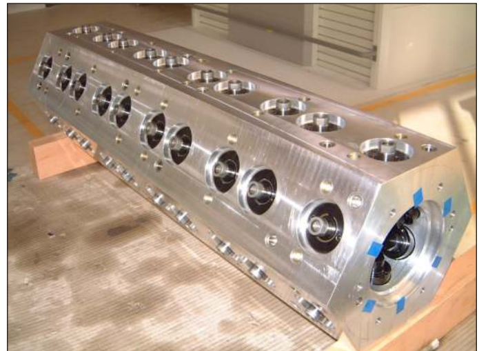
Corps du dispositif équipé de vérins à corps fileté hydrauliques
