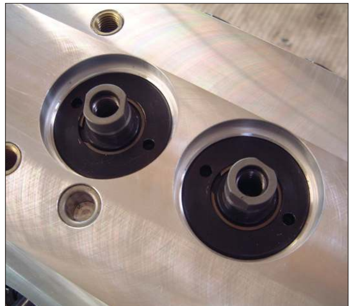
Vérins à corps fileté hydrauliques, à simple effet avec ressort de rappel
