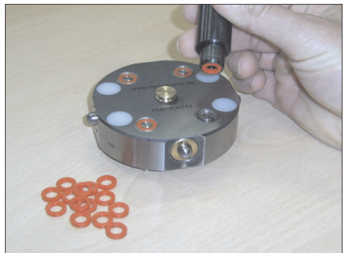
Das Montagewerkzeug im Einsatz an einer Kupplungsplatte, in der Mitte ist eine federbelastete Blasdüse zu erkennen.
