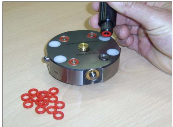
L'outil d'assemblage utilisé sur une plaque d'accouplement, au milieu on peut voir une buse soufflante montée sur ressort.
