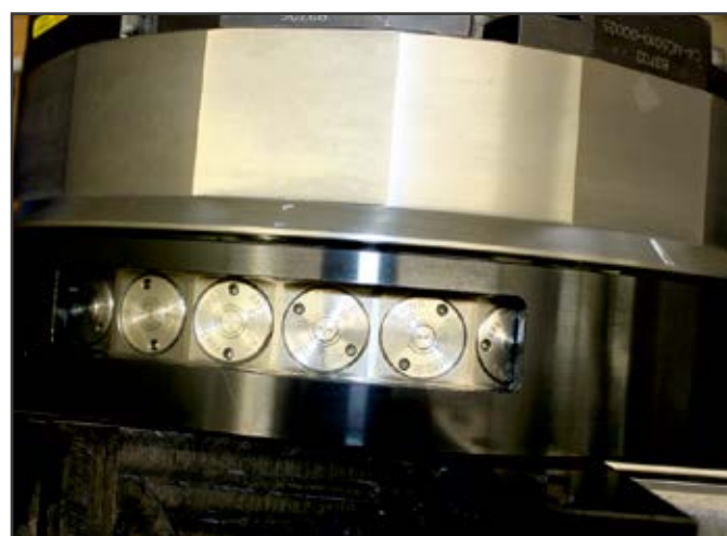
Kupplungsnippel im Revolver mit 36 Kupplungsnippeln
