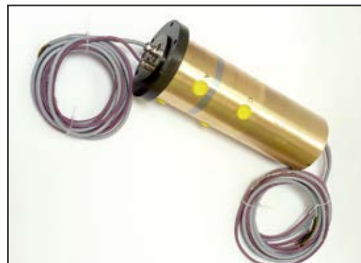
Drehdurchführung, 3-adrig, Druckluft, Hydrauliköl und Profibus 24 VDC
