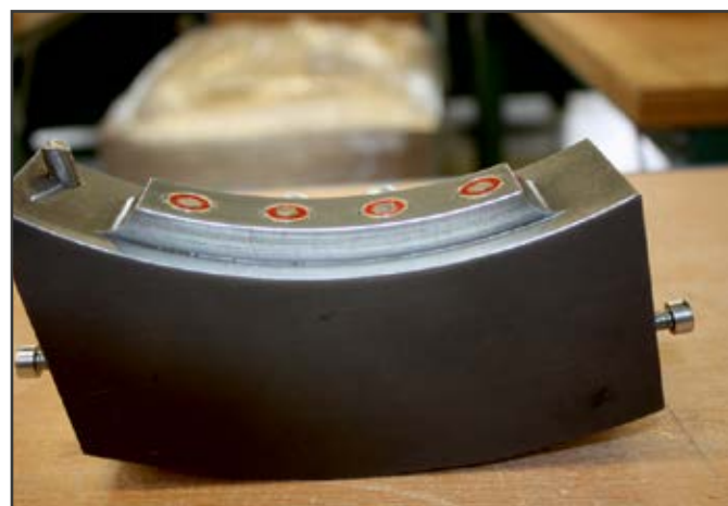
Aufnahmeblock mit automatischen Kupplungsmechaniken
