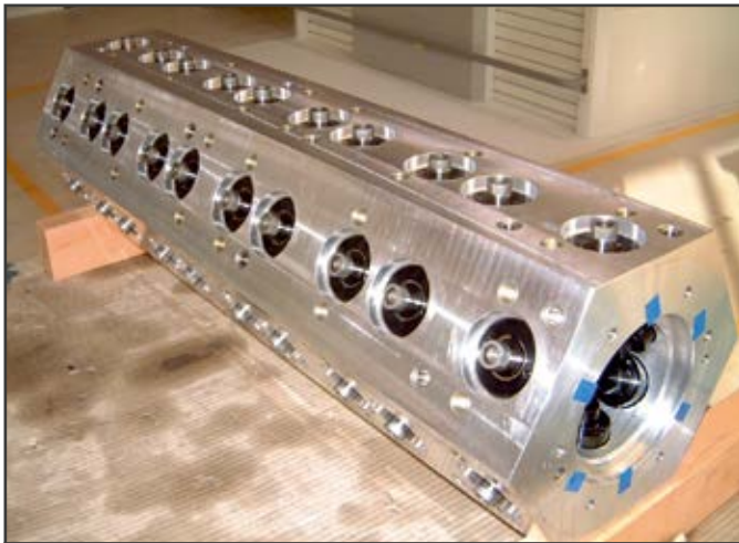
Einschraubzylinder im Vorrichtungsgundkörper
